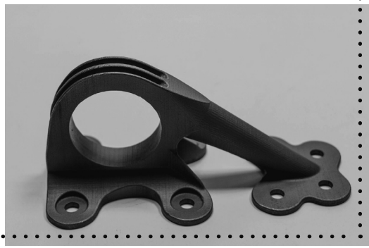
Großes Aufsehen erregte der Prototyp einer Halterung, die mit 3D-Druckern im Laserschmelzverfahren aufgebaut wurde. Dieses Verbindungselement für Flugzeuge wurde früher aus Alu gefräst.
