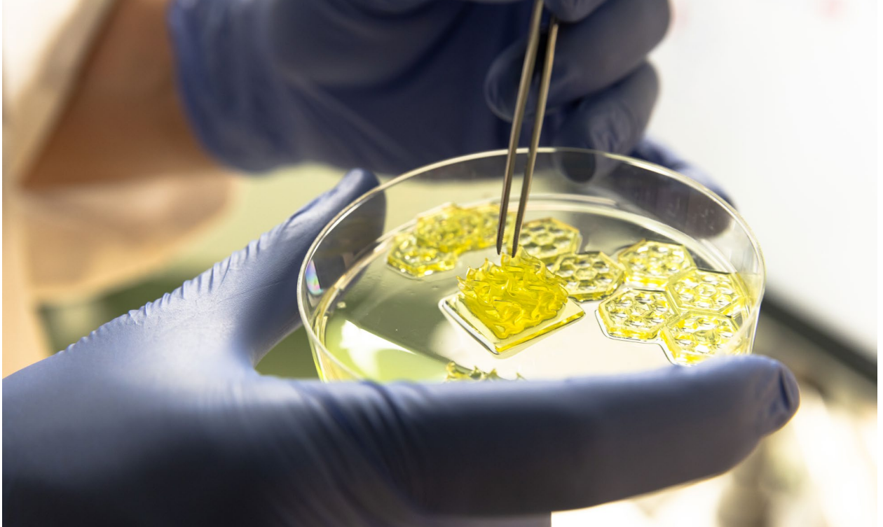
Nahaufnahme 3D gedruckter Hydrogele. Die Hydrogele können in herkömmlichen Zellkulturgefäßen gelagert und kultiviert werden.
