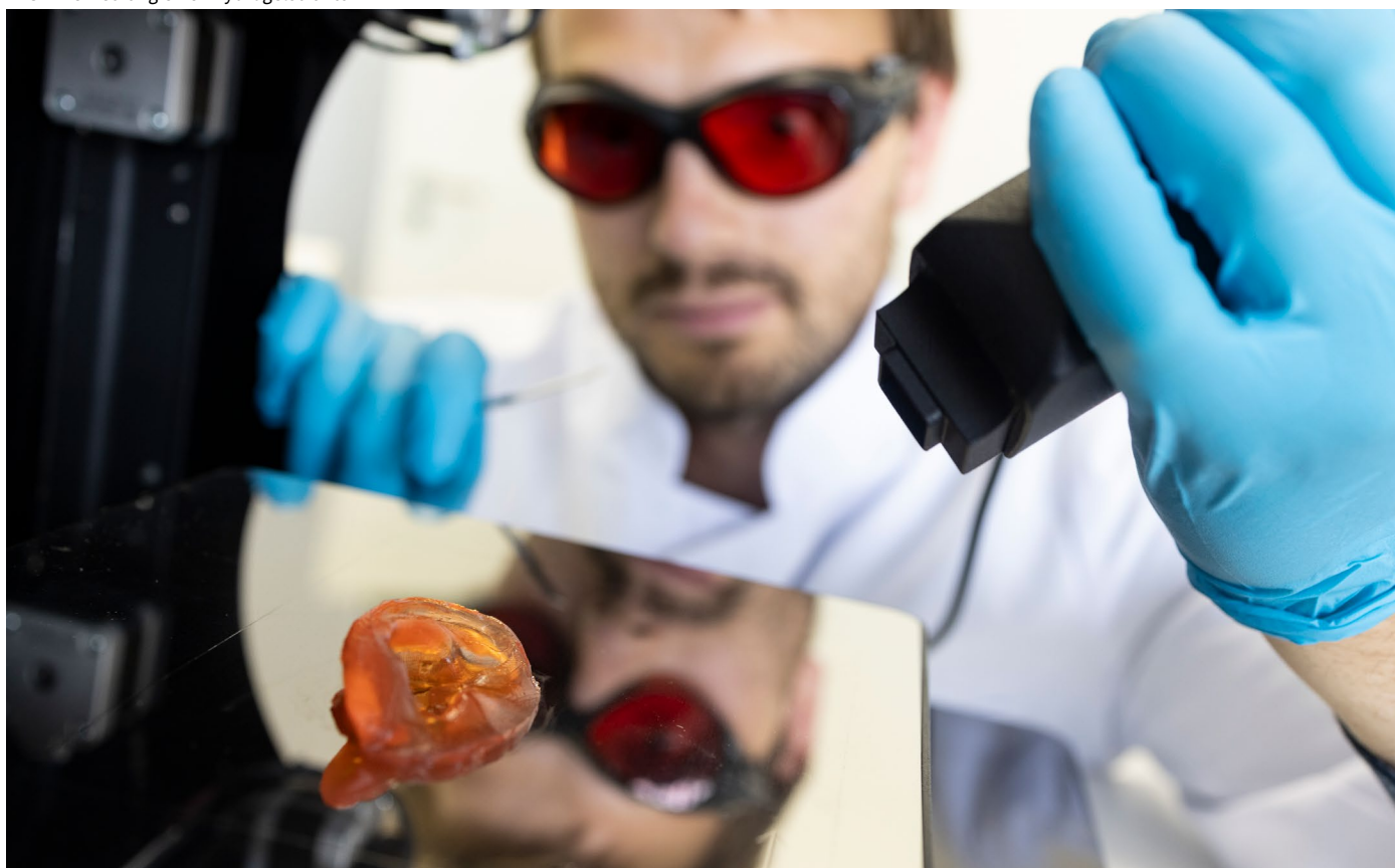
UV-Vernetzung einer Hydrogelstruktur
